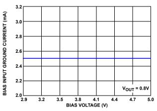
FIGURE 14. INPUT GROUND CURRENT vs VBIAS
