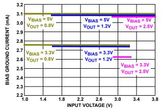
FIGURE 15. BIAS GROUND CURRENT vs  $V_{\mbox{\scriptsize IN}}$  and  $V_{\mbox{\scriptsize OUT}}$
