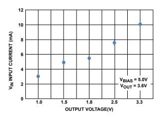
FIGURE 17.  $V_{IN} I_{O}$  vs VOUT VOLTAGE
