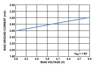
FIGURE 16. BIAS GROUND CURRENT vs  $V_{\mbox{\footnotesize BIAS}}$
